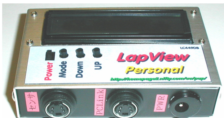
センサ 接続端子 PCケーブル 接続端子 電源ケーブル 接続端子
